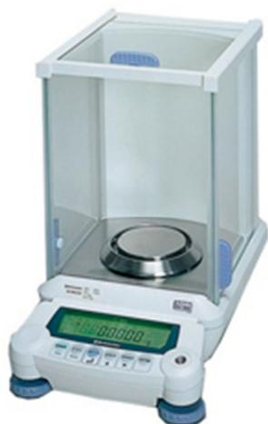
As balanças da série AU são as mais recentes balanças analíticas de escala única projetadas com a tecnologia unibloc. Proporcionam respostas rápidas e excelente estabilidade. O sistema unibloc é produzido pelo processo de descarga elétrica de alta precisão através de condutores à um bloco de alumínio, substituindo dessa forma os mecanismos de sensores eletromagnéticos.
