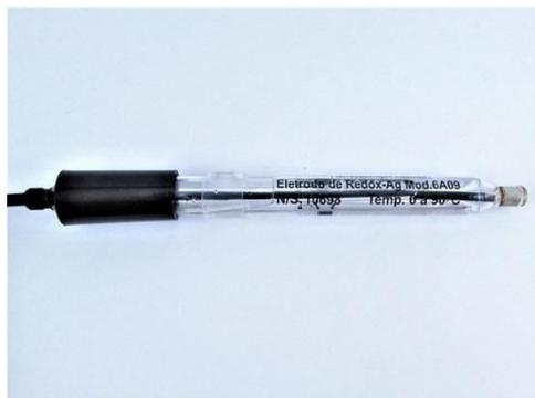
Eletrodo combinado ORP Analyser, anel de prata, usado em laboratórios. O eletrodo de prata é recomendado para a maioria das reações redox, possui corpo em vidro, cabo de 1 metro e conector BNC.
