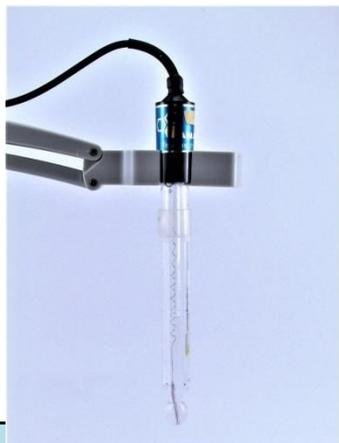
Eletrodo de pH combinado Analyser, usado em laboratórios ou indústrias onde prevaleçam condições normais, possui sistema de referência Calomelano, corpo em vidro, cabo de 1 metro e conector BNC.
