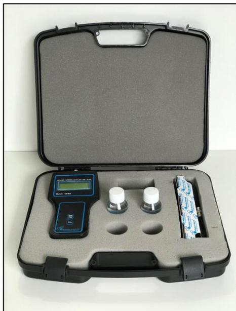
O medidor de pH e Íons digital Microprocessado portátil Analyser modelo 150MA é um instrumento para laboratório ou campo, preciso, rápido, de fácil calibração e compacto, que combina medição de pH, milivolts, ISE e temperatura de uma amostra.
