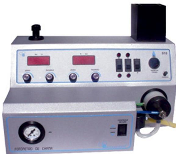
Os Fotômetros de chama Analyser 910, são equipamentos para dosagem de Sódio e Potássio com filtros opcionais para Cálcio e Lítio. Com eletrônica de estado sólido, detectores de alta sensibilidade e filtros interferênciais. Este modelo permite leituras estáveis e reprodutíveis para uso em análises clínicas e laboratórios de indústrias de alimentos, cerâmica, fertilizantes, cimento, bebidas, etc...
